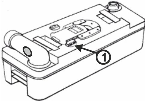
An den Fäkal tanks befindet sich ein ständig geöffnetes Überdruckventil. Dieses Ventil wird durch die SOG-Toilettenentlüftung überflüssig und muss verschlossen werden, da ansonsten während der Fahrt hieraus Gerüche austreten und somit ins Servicefach und dadurch ins Fahrzeuginnere gelangen.
