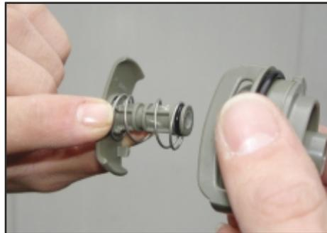
**3. Ventilbetätigung aus dem Ventil ziehen und Spiralfeder entfernen.**
