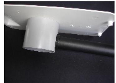
Anschlussplatte wieder in das hintere Fach einsetzen
