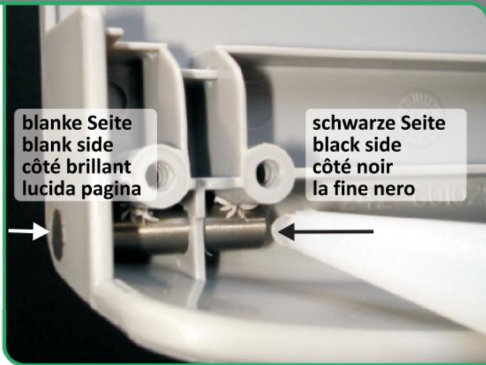
**D** Schwarzgekennzeichnete Stirnseite des Steuermagnets **in Pfeilrichtung** in die Bohrung einschieben, bis dieser mit der Außenseite des Schiebergriffes (blanke Seite) abschließt.
