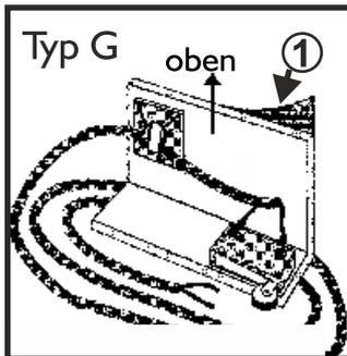
Vor dem Einkleben die Klebefläche an der Kunststoffwand mit Bremsenreiniger oder Alkohol reinigen.
