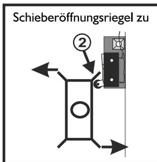
Der Aluminiumwinkel muss so eingeklebt werden, dass die Gleitrolle ② des Microschalters genau vor der Schräge des Schieberöffnungsriegels anliegt.
