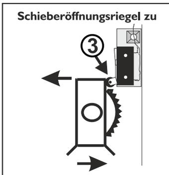
HINWEIS: Bei gedrücktem Schalter ist die Stromzufuhr unterbrochen, so dass nur bei geöffnetem Schieber der Lüfter eingeschaltet wird.
