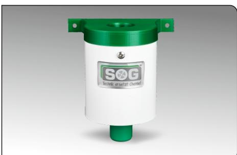
Hierfür den Schlauch unten abziehen und die Schraube lösen. Die Filterpatrone durch leichtes Drehen nach unten ziehen. Filtereinheit wird komplett ersetzt und wieder mit der Schraube befestigt.
