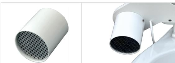
Die zwei Schrauben abschrauben und die Filterpatrone durch leichtes Drehen nach unten abziehen. Filtereinheit wird komplett ersetzt und wieder mit den zwei Edelstahlschrauben befestigt.
